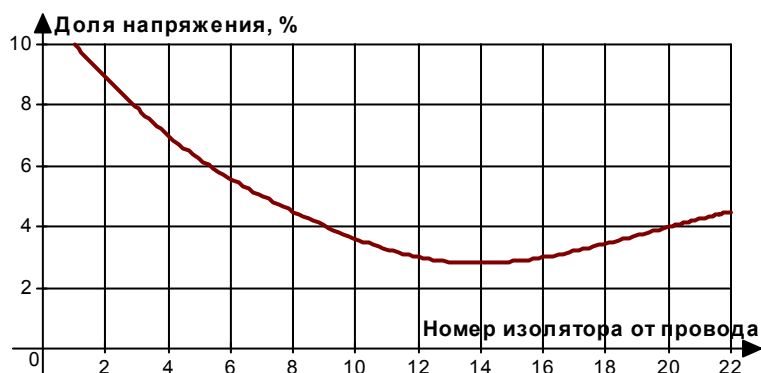
Рис. 2.5. Доля напряжения на изоляторах в гирлянде из 22 изоляторов
